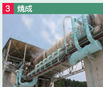
3 焼成 キルン内では1350℃以上の高温で焼き、ダイオキシン類を分解し、クリンカ（塊）をつくります
