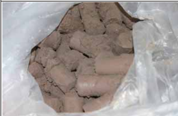
この飛灰固化物を受領し、循環組合で委託分析した結果、測定値（10/5速報値）は法令に定める基準値を満足していることを確認
