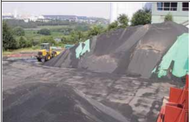
溶融スラグは、屋外のストックヤードで保管
