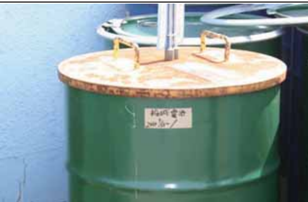
乾電池を保管しているドラム缶には、搬入元と保管開始日を明記
