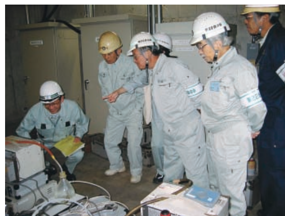
エコセメント化施設における排出ガス調査
